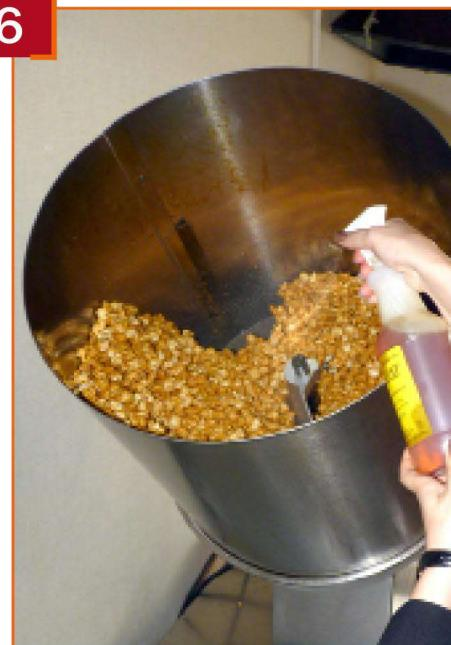
Во процессе перемешивания попкорна в карамелизаторе распыляем сепаратор на стеки котла и попкорн.
