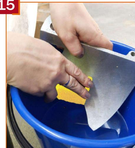
Промойте лопасти в чистой проточной воде.
