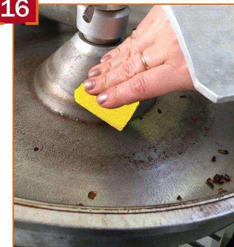
Мягкой губкой удалите из котла остатки загрязнений и чистящего средства, промойте проточной, чистой водой 2-3 раза.
