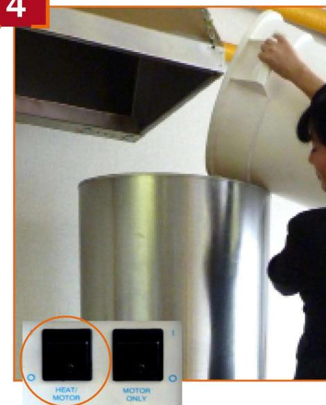
После подачи сигнала о готовности смеси **выключаем тумблер «нагрев» HEAT/MOTOR.**
