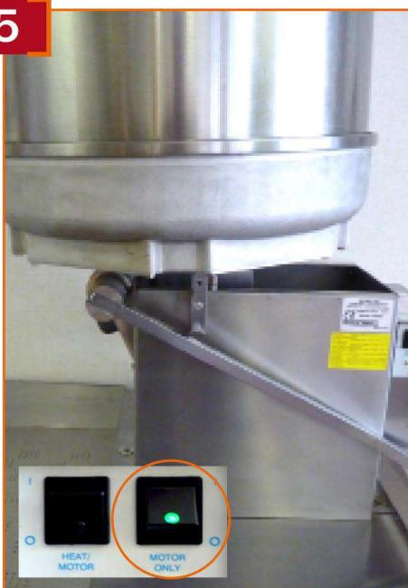
**Включен тумблер MOTOR/ONLY.** Ручка находится в положении N1 (котел расположен вертикально).
