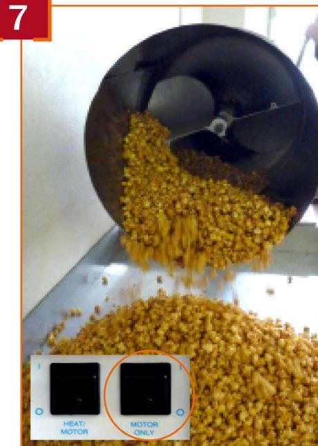
Когда попкорн равномерно и полностью будет покрыт карамелью, **выключаем тумблер MOTOR/ ONLY.**
