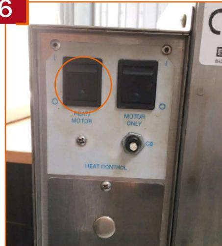
Выключаем тумблер «нагрев» HEAT/MOTOR.
