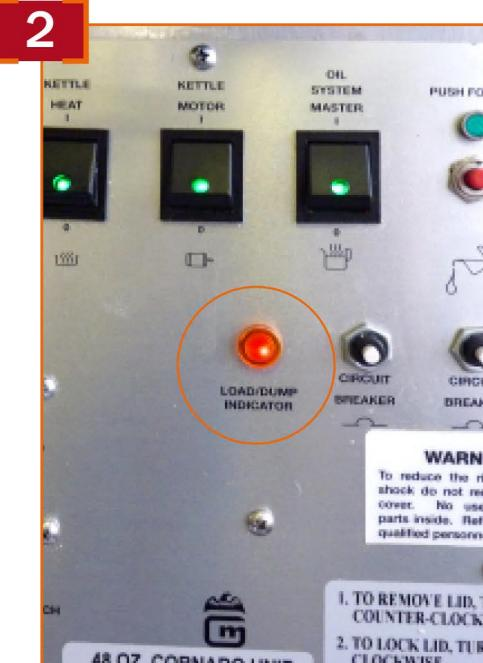
На панели аппарата загорится красный индикатор LOAD/DUMP INDICATOR и раздастся звуковой сигнал, предупреждая, что котел аппарата нагрелся до необходимой температуры.
