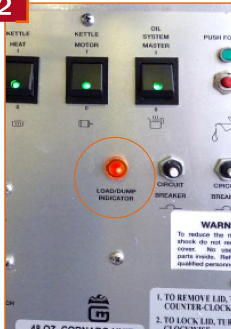
На панели аппарата загорится красный индикатор LOAD/DUMP INDICATOR и раздастся звуковой сигнал, предупреждая, что котел аппарата нагрелся до необходимой температуры.
