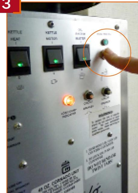
После подачи сигнала о готовности нажать на панели аппарата кнопку красного цвета PUSH FOR OIL (подача масла).
