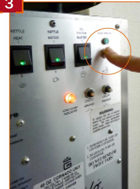
После подачи сигнала о готовности нажать на панели аппарата кнопку красного цвета PUSH FOR OIL (подача масла).
